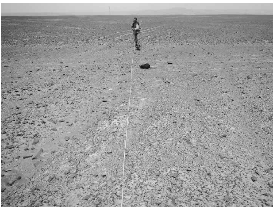
（巻き尺を用いて、直線の地上絵を測量している場面）
